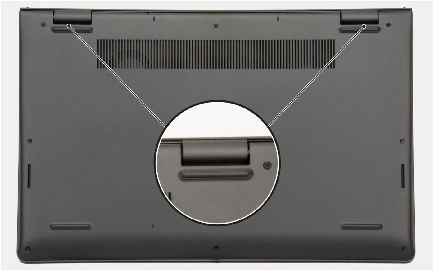
3. Hebeln Sie die Oberseite der Bodenabdeckung auf und arbeiten Sie auf der linken und rechten Seite weiter, um die Bodenabdeckung zu öffnen.
