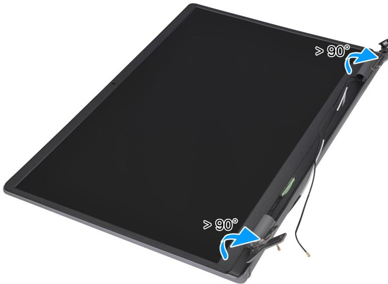
2. Hebeln Sie mithilfe eines Kunststoffstifts die linke Bildschirmscharnierabdeckung von der rechten Seite ab und entfernen Sie sie vom linken Bildschirmscharnier.
